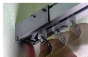
ランナー挿入後にハッチは自動で閉まります。
